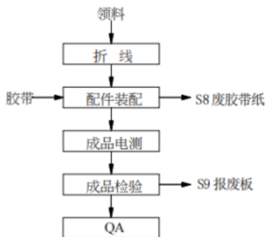
图 2.9 装配工艺流程及产污环节示意图
