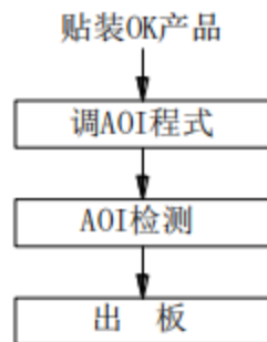
图 2.8 AOI 工艺流程示意图
